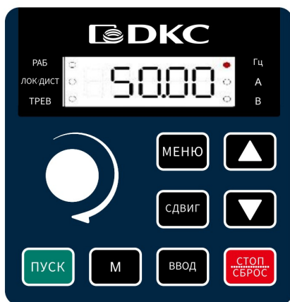
Рисунок 4-6 Дисплей после включения питания
