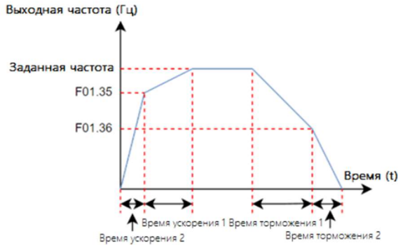
Рисунок 5-28 Схема переключения времени ускорения и торможения
