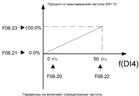
Рисунок 5-10 Типичная кривая настройки для DI4
