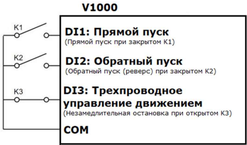
Рисунок 5-3 Подключение и настройка параметров трехпроводного режима 1
