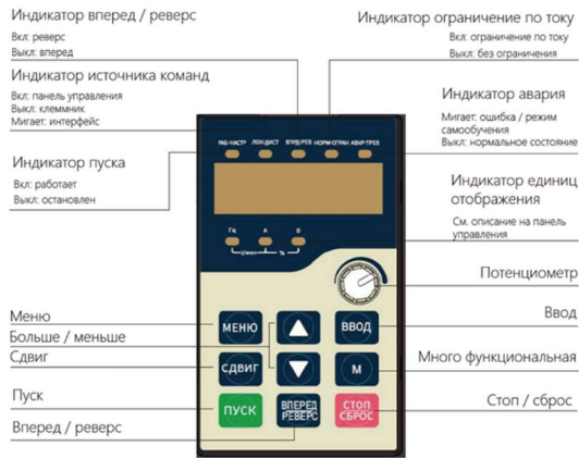
Рисунок 4-2 Описание функций кнопок внешней панели
