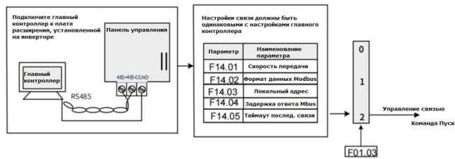
Рисунок 5-5 Настойка связи для управления по протоколу
