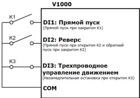
Рисунок 5-4 Подключение и настройка параметров трехпроводного режима 2
