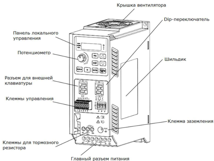
Рисунок 2-1 Принципиальная схема элементов преобразователя частоты
